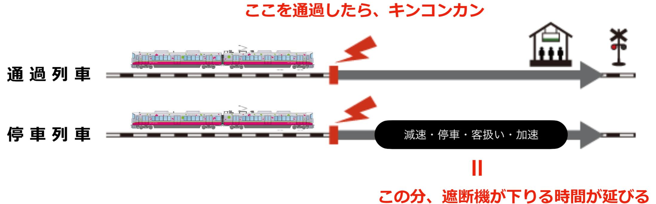
● その路線の最高速度の列車がその速度に踏み切りに向かってくることを前提に、警報器、遮断機を作動させている。
